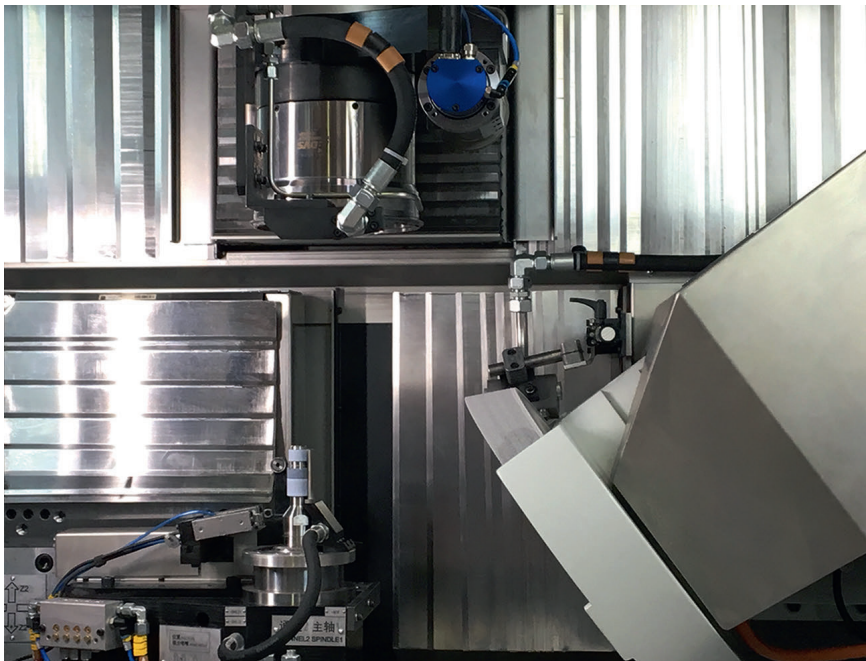
1 Blick in den Arbeitsraum der Buderus CNC 235: simultane Außen- und Innenschleifbearbeitung in einer Aufspannung (© Buderus)
